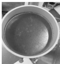
Cột 1 sau 3 ngày tự làm sạch, mặt nước xuất hiện váng đen
